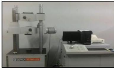
Gambar. 3.11. Mesin Uji Tarik
