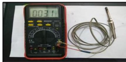
Gambar. 3.5. Multimeter Suhu dan Termokopel
