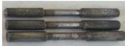
Gambar 3.15. *Specimen* yang akan Di Uji Tarik.
